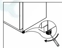
(Поворот колесика по часовой стрелке приподнимает дверцу, против часовой стрелки — опускает).
