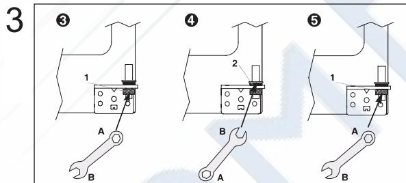
Закрепите гаечный ключ (сторону А) на гайке шарнирного болта (1) и открутите гайку, поворачивая ключ по часовой стрелке.
